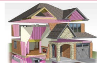
①断熱材の使用箇所
