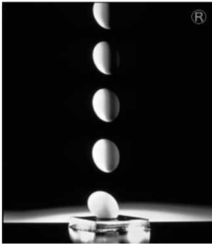
図3 落下する生卵を割らずに受ける \alpha GEL ® シートを示す写真(株)タイカのホームページからの転載)
