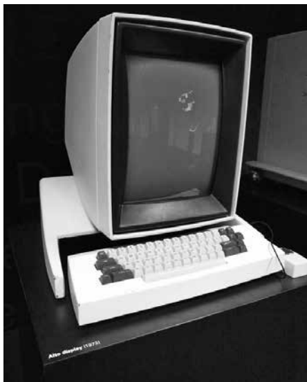
図4 ALTO (PARC内, 著者撮影) : ビットマップディスプレイ, キーボード, マウスから構成され, WYSIWIGのグラフィカルユーザインタフェースを備える現代のパーソナルコンピュータの原型と言われる。
